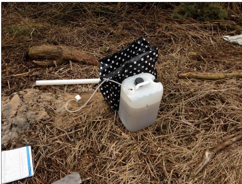
Figur 7. 2018-04-09, rensumpning och omsättning av grundvatten i provpunkt 18ÅF02. Foto: ÅF Infrastructure AB 2018.
