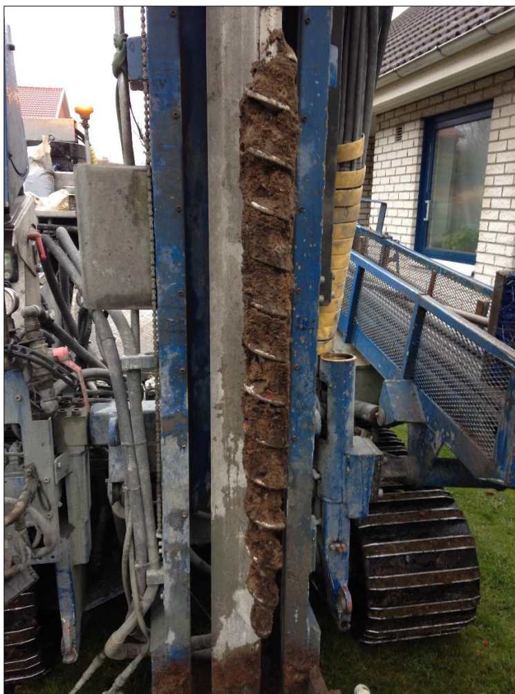
Figur 5. En blandning av grus, lera och sand med inslag av tegel i provpunkt 17ÅF01 (2 till 3 m u my). Foto: ÅF Infrastructure AB, 2017.
