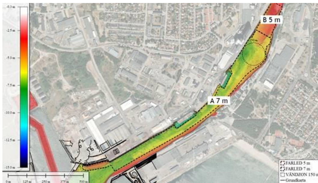
Figur 3-1 Skiss av befintliga farleder och djup baserade på mätningar jan-feb 2020 av Marin Miljöanalys AB. Område A är farled och B inre hamn.
